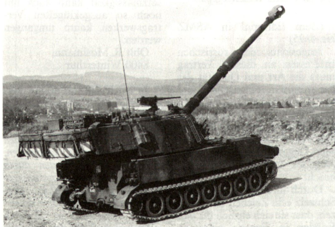
Kampfwertsteigerung Panzerhaubitze M-109. Äussere Merkmale: längeres Geschützrohr, Flecktarnanstrich und «Rucksack» am Turmheck, welcher ermöglicht, mehr Munition mitzuführen.
