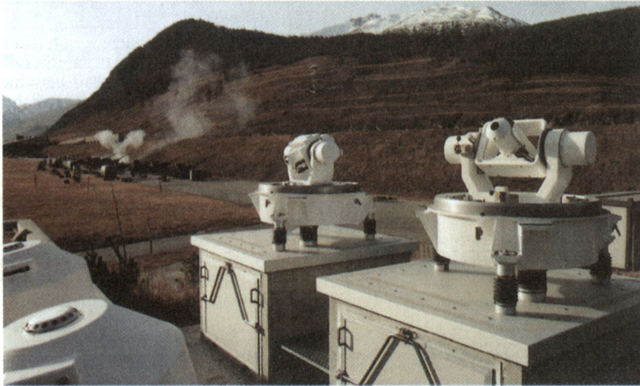
Abb. 2: Elektro-Optik-Einheit für Ziel- und Schusserfassung der Schussfehlervermessungs- und Trainingsanlage SFV 90 für Fliegerabwehrschussplätze. (Oerlikon-Contraves)
