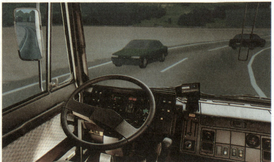
Abb. 3: Reale LKW-Führerkabine mit computer-generierter Sicht des Fahrersimulators ADAMS (Advanced Driving And Manoeuvring Simulator) für Lastwagen. ADAMS ist die zivile Version von FATRAN. (Oerlikon-Contraves)
