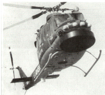
Beobachtungshelikopter Creso, ausgerüstet mit modernem Überwachungsradar.
