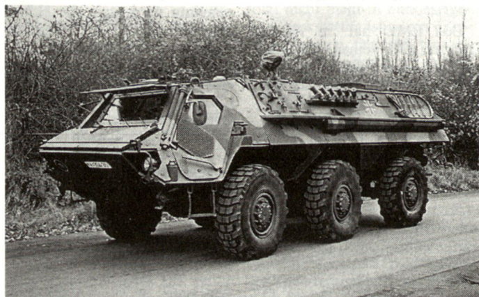
Aufklärerversion des Transportpanzers Fuchs, ausgerüstet mit modularer Zusatzpanzerung gegen Beschuss, Splitter und Minen.
