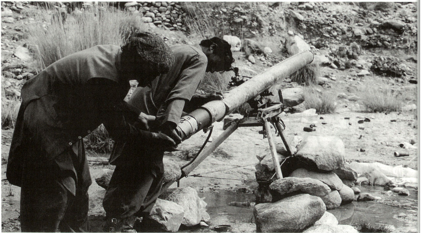
Abb. 2: Tragbarer, einrohriger Raketenwerfer «Grad-P» 122 mm mit Reichweiten von 11 bzw. 20 km, je nach verwendetem Raketentyp.
