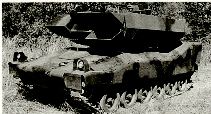
Prototyp des schweren Panzerabwehrsystems LOSAT auf Fahrgestell des «Bradley».
