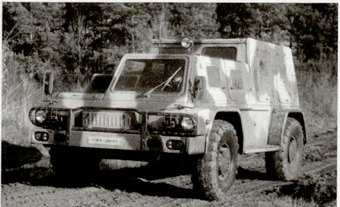
Mehrzweckfahrzeug GAZ-3937 für die neuen Aufgaben des russischen Heeres.
