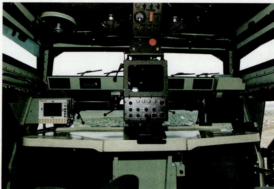
**Innenansicht des Fahrzeuges für Schiesskommandanten: Arbeitsplätze des SKdt (rechts) und des Vermessers (links).**
