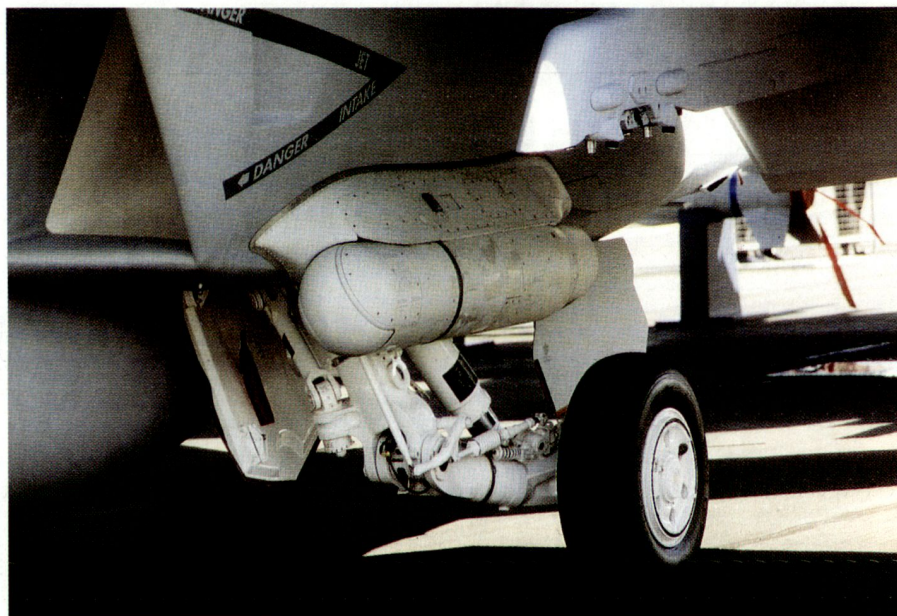
Linkes Haupttradbein mit Raytheon Advanced Targeting Forward Looking Infra-Red (ATFLIR) system.
