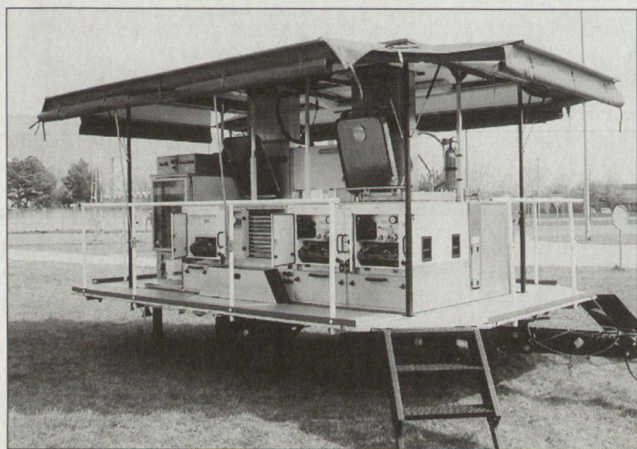
Der Prototyp einer mobilen Küche hat die Kapazität von 400 Portionen pro Mahlzeit, wiegt knapp 4 Tonnen und verfügt sowohl über einen Kühlschrank, einen Kombi-Dämpfer (Backofen) sowie einen Durchlauferhitzer.
