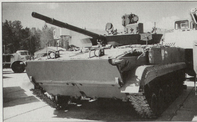
Schutzsystem «Arena 2» auf einem Kampfschützenpanzer BMP-3; erkennbar sind der Kassettenkragen am Turm und die Sensorik zuoberst in der Turmmitte.
