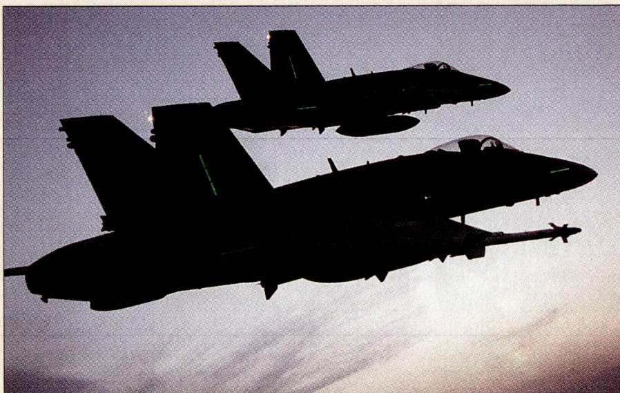
Zwei F/A-18E im Gegenlicht. Gut sichtbar die fluoreszierenden Streifen am Rumpf und Seitenruder. Diese dienen als Markpunkte beim Dämmerungs- und Nachtpatrouillenflug.
