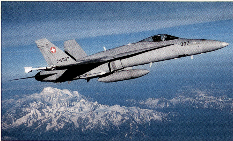
Mit «scharfer» Munition im Einsatz. Der F/A-18E mit Sidewinder (Flügelende) und AMRAAM (unter dem Flügel).
