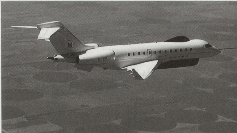
Sentinel R.1 der Royal Air Force in der Erprobungsphase. Die SAR-Antenne ist in der kanuförmigen Verkleidung unter dem Rumpf angebracht, die SAT-Verbindung ist auf dem Rücken angeordnet. Bild: Royal Air Force, Crown Copyright
