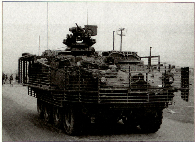
Zum Schutz gegen RPGs sind die Schützenpanzer «Stryker» im Irak mit einer Gitterrostpanzerung versehen worden.
