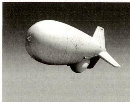
JLENS, ein gefesselter Aerostat, welcher in seiner Gondel ein Zielsuch- oder ein Zielfolgeradar aufweist. Er soll die rechtzeitige Entdeckung und Verfolgung von LACM aus überhöhter Position sicherstellen und Feuerleitdaten für die GBAD liefern. In einem künftigen Konflikt, in welchem die US-Streitkräfte involviert sind, dürfte dieses System ein Standard-Asset darstellen.
