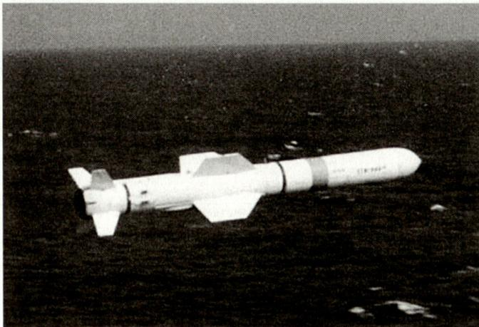
Eine Antischiffslenkwaffe AGM-84 HARPOON während des Marschfluges wenige Meter über der Meeresoberfläche. Da diese Lenkwaffe von einem Turbojet angetrieben wird, ist der Aufwand, welcher beim Umbau in eine LACM entsteht, verhältnismässig klein. Trotzdem verfügt die diesbezüglich optimierte Version AGM-84J (HARPOON BLOCK II) nur über beschränkte LA-Fähigkeiten.
