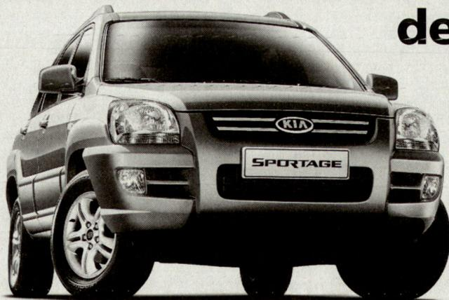
Motoren: 2.0-I-CRDi mit 112 PS; 2.7-I-V6 mit 175 PS. Manuell oder 4-Stufen-Automat H-Matic (2.7 l), perm. 4WD, 8 Airbags, ABS mit EBD, Traktionskontrolle, ESP/BAS (2.7 l), Nebelscheinwerfer, Tempomat, Servolenkung, Zentralverriegelung, Alarmanlage, Klimaautomatik, Radio/CD usw.
