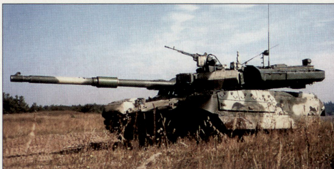
Ukrainischer Kampfpanzer T-84 «Oplot», ausgerüstet mit 120-mm-Kaliber.
