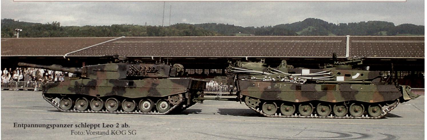
Entpannungspanzer schleppt Leo 2 ab.
