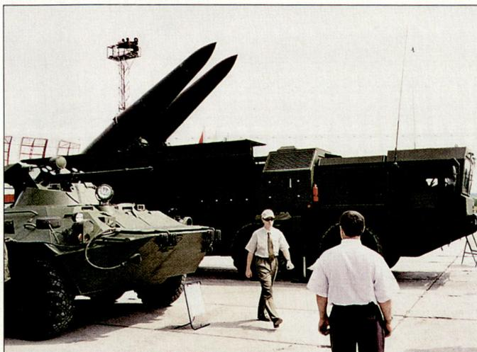
Das Werferfahrzeug des Lenkwaffensystems «Iskander-M» ist mit zwei Raketen bestückt.
