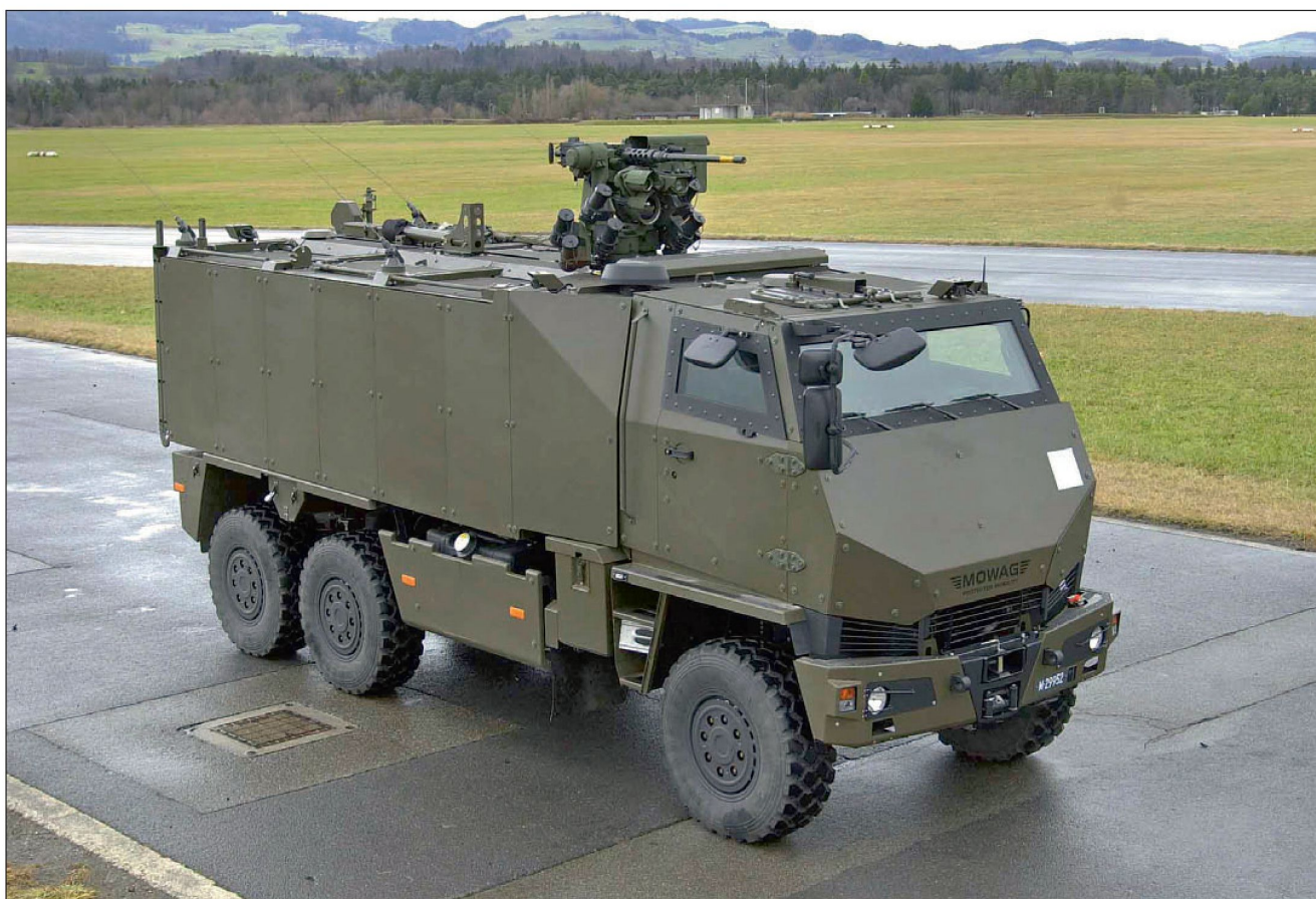
Aussenansicht GMTF mit fernbedienbarer und stabilisierter Kongsberg Waffenstein «Protector».
