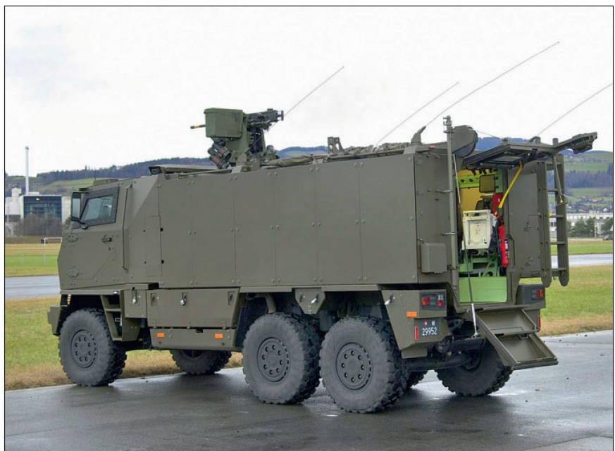
Aussenansicht GMTF mit geöffneter Ausstiegsklappe.
