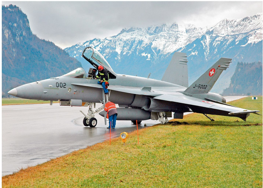
8. Januar 2007: Landevorfall. F/A18 drehte um die eigene Achse. Unfallursache: Technische Störung im Fahrwerkgestänge.
