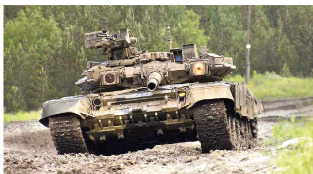
Softkill-System «Shtora» auf dem russischen Kampfpanzer T-90S.
