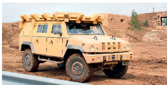
Mehrzweckfahrzeug LMV mit abstandsaktivem Schutzsystem ADS.
