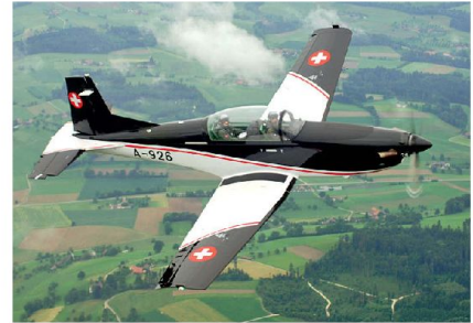
Prototyp anlässlich Flugversuche neues Cockpit und Sichtbarkeitsabklärungen.
