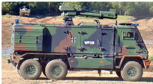
Impulswasserwerfer auf Geländelastwagen «Duro». Bild: Bundeswehr
