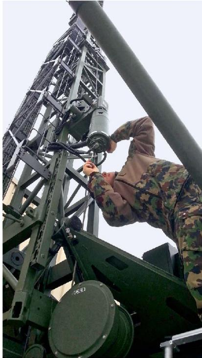
Der neue KOMPAK Pz: Der Notabbau des Mastens wird überprüft.
