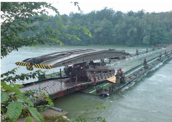
Abb. 2: Panzerbrücke 68/88 auf Schwimmbrücke 95.
