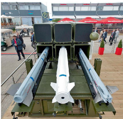
Der NASAMS II Werfer kann mit verschiedenen Lenkwaffen, wie AMRAAM, ESSM oder AIM 9X bestückt werden.
