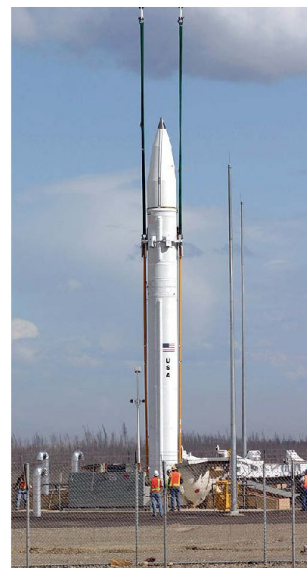
Eine GBI-Abfangrakete wird in einen Abschussilo geladen.
