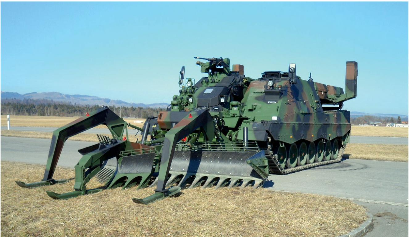
Minenräumpfzug mit angebautem elektromagnetischem Auslösesystem und einem Gassenmarkiersystem) sowie total 4 Minenschutz-Kits zur Verfügung. Diese Aufteilung erlaubt ein breites Einsatzspektrum vom Bau künstlicher Hindernisse oder Feldbefestigungen bis zum Durchbrechen und Markieren von Minensperren, je nach Aufgabentyp und Bedrohungslage.
