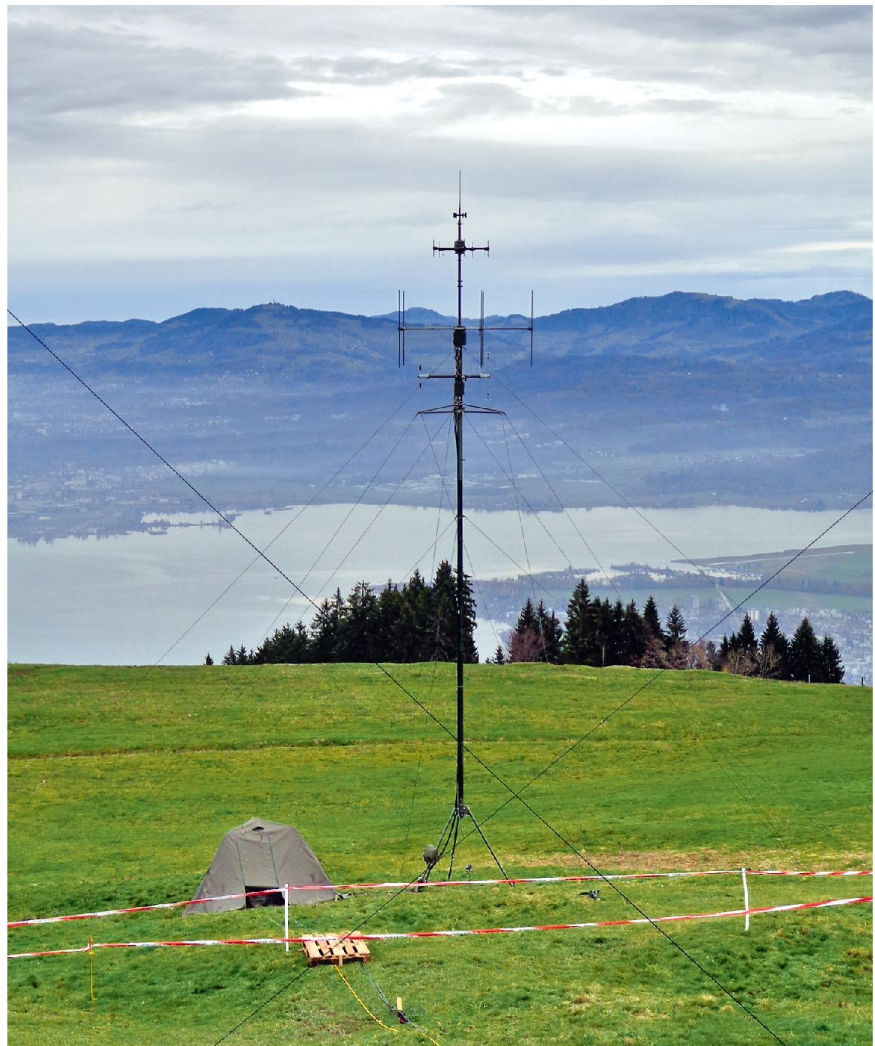
Im Modul «VERDE COMINT» werden die militärischen Netze des Leistungsbezügers mit Peilantennen (Sensoren) aufgeklärt.
