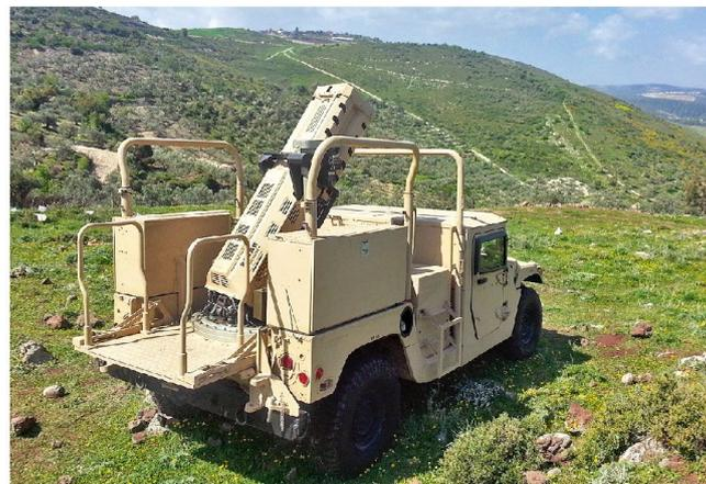
Autonomer leichter Minenwerfer für den Einbau auf leichten Geländefahrzeugen.
