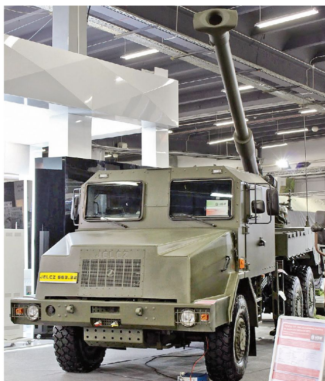
Selbstfahrgeschütz 155 mm «Kryl» auf Geländelastwagen «Jelcz».
