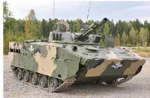
Der neue Luftlandepanzer BMD-4M mit Kanone 100 mm und 30-mm-Automatenkanone.
