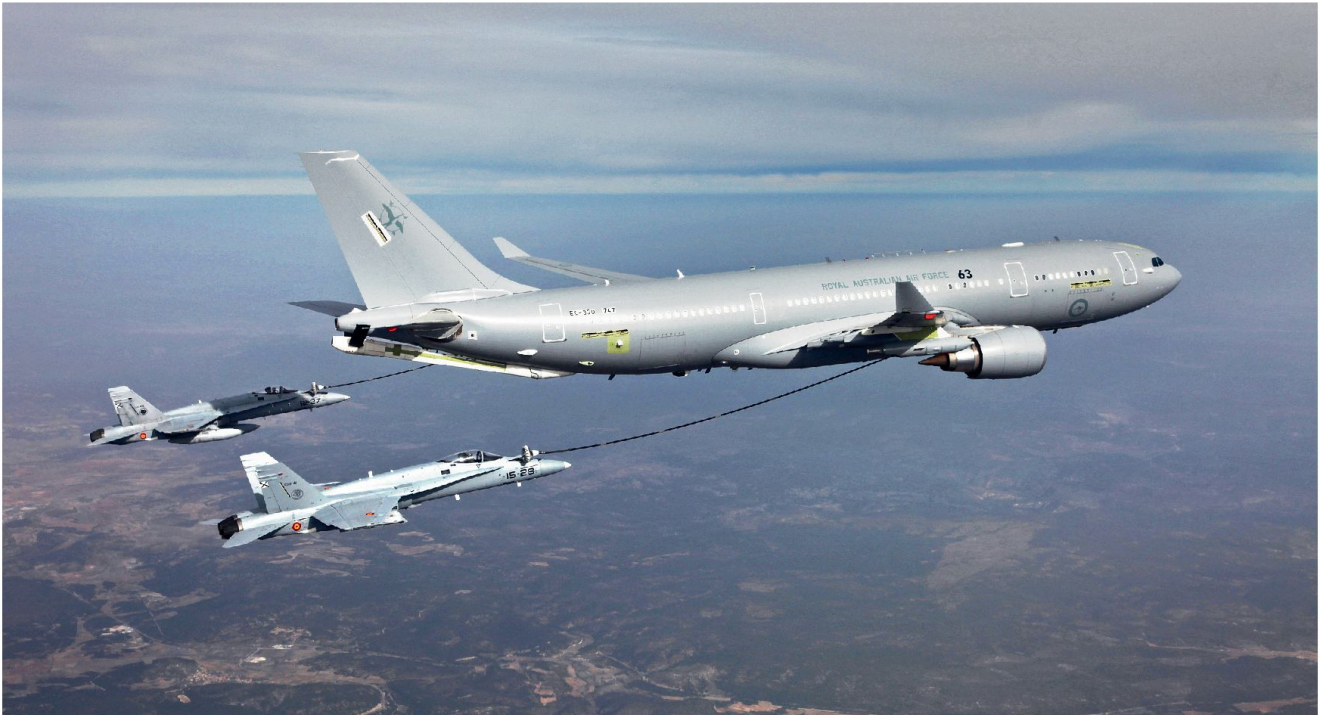
Abb. 4: Tanker Airbus A330MRTT mit 2 F/A-18. Bild: Airbus Military
