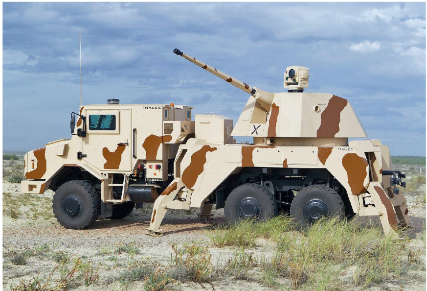
RAPIDFire Kanonenfahrzeug mit 40mm-Flugabwehrkanone. Bild: Thales Air Systems
