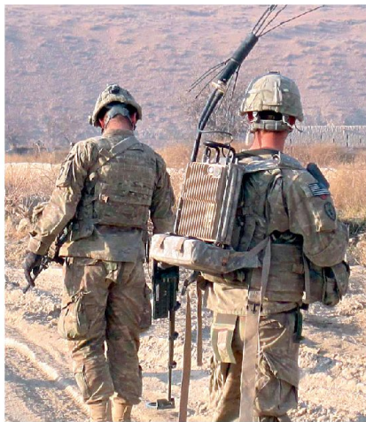
Mit tragbaren oder fahrzeuggestützten elektronischen Störgeräten soll die Fernzündung von Sprengladungen mittels Funksignal verhindert werden.
