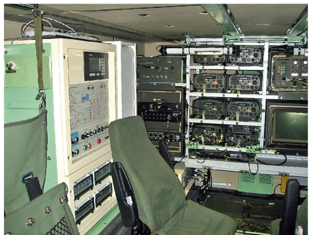
Innenansicht eines Radio Access Point Panzers (RAP Pz): Integration von Telekommunikationsausrüstung auf engstem Raum.
