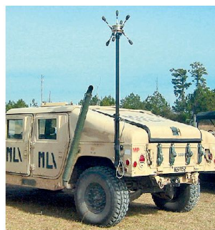
Aufklärungsfahrzeug «Humvee» ausgerüstet mit «Gunshot Detector» vom Typ «Boomerang».
