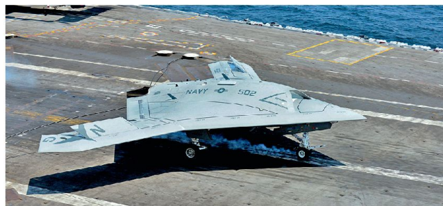
Das unbemannte Kampfflugzeug X-47B soll autonom von amerikani- schen Flugzeugträgern operieren können. Bild: US Navy
