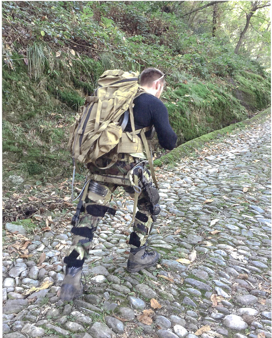
Testmarsch mit Exoskelett und Last.
