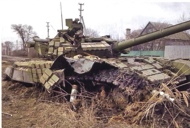
Zerstörter Kampfpanzer T-64BV, Schwachstelle Laufwerk.
