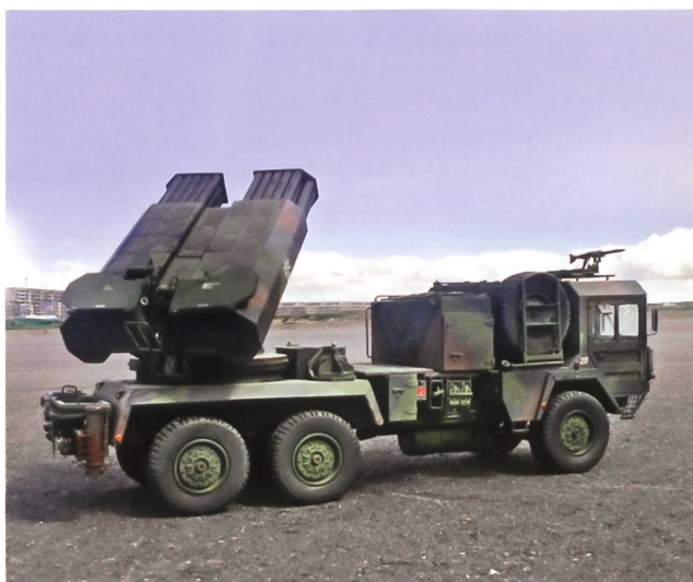
LARS (Leichtes Artillerieraketensystem 110 SF auf Fahrgestell MAN 6×6).
