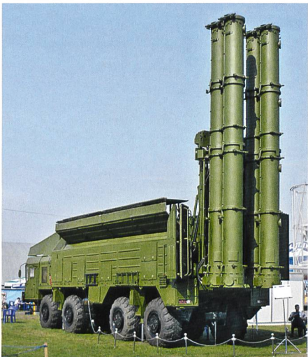
Modifiziertes Abschussfahrzeug mit vier Startvorrichtungen für 9M729.
