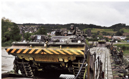
Ein Bergepanzer Büffel (65t) überquert bei Rottenschwil AG die Reuss über eine Schwimmbrücke 95. Im Hintergrund ein Pionierpanzer Kodiak. Bild: Autor
