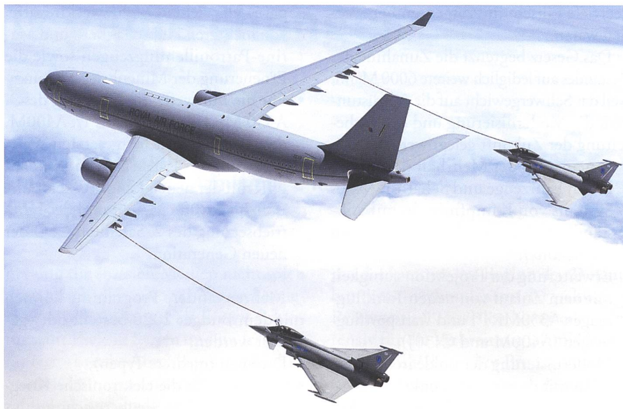
Tankflugzeug A330MRTT betankt zwei Rafale. Bild: Airbus
