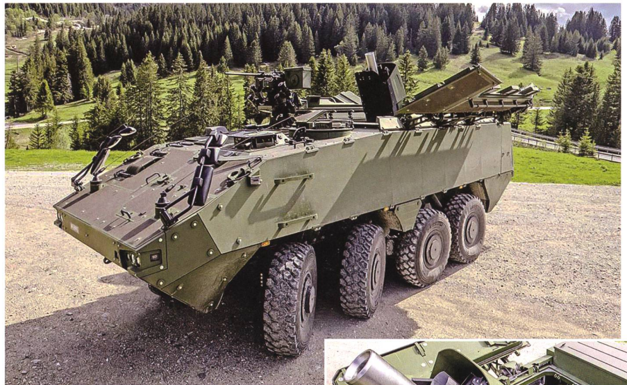
Panzermörser 16 mit geöffneten Geschützraum-Deckeln. Bilder: VBS/DDPS
