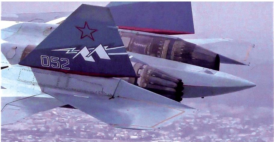
Die neuen Triebwerke beim Su-57 Stufe 2.
