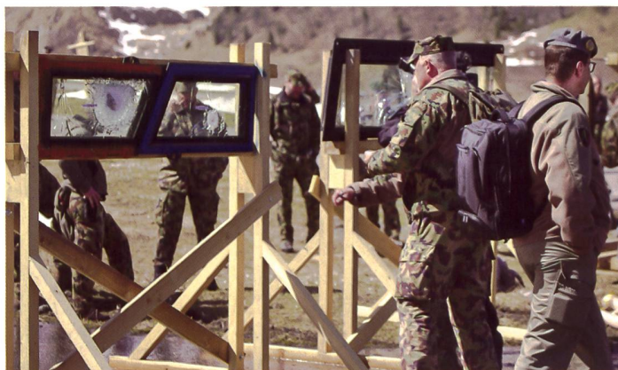
◀ Panzerglas: Die Scheiben des Mowag Eagle haben Gewehr- und Panzerkugeln verschiedener Kaliber abgehalten.
