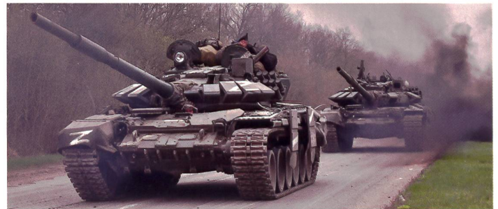
▲ Kpz T-80 mit Reaktivpanzerung Kontakt 1.
