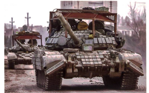
▼ Kpz T-72 mit improvisiertem Zusatzschutz gegen Beschuss von oben.
