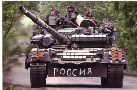
▲ Kpz T-80 mit Reaktivpanzerung Kontakt 1.
