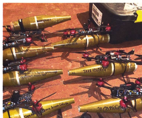
Beispiele ukrainischer Improvisation: Man nehme eine handelsübliche Renndrohne und den 85 mm-Gefechtskopf einer RPG-7-Panzerfaust und fertig ist die «Kamikaze-Drohne». Bild: via Twitter
